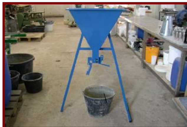
شکل 4- ابزار آزمایش لزجت (V-funnel)
