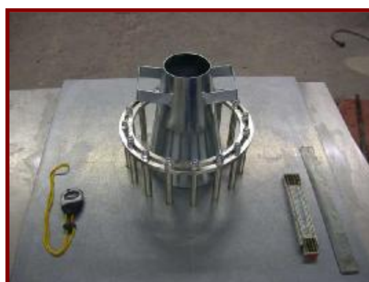
شکل 1- وسایل آزمایش جریان اسلامپ
